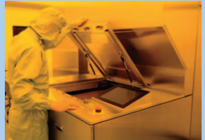
上記写真は露光作業を行うエロールーム (紫外線カット用ライト)にて撮影。実際の製品色とは異なります。
