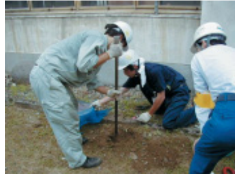
土壌重金属調査（表面掘削）
